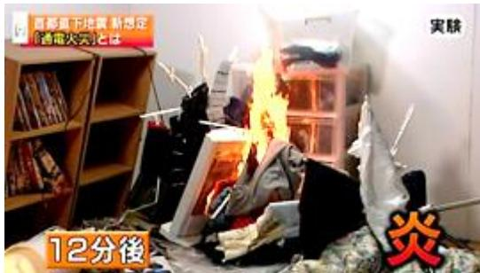
大地震が発生すると、電力線の断絶などが起こり、電気の供給がストップします。その後、数時間から数日後に電気の供給が復旧しますが、その時に起る火災を「通電火災」と言います。破損したり、倒れた電気器具に通電して火災が発生(電気ストーブなどに衣類が掛かり引火)したり、ガスが漏れているところに通電して発火したり、壊れたコンセントやちぎれた電気配線に通電して発火したり、原因はさまざまです。
